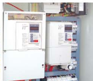
PT7528、PT7023 塔机的三大机构采用全变频控制, 调速性能好, 整机运行平稳、冲击小。
