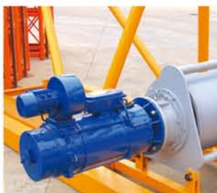
PT7528、PT7023 塔机的三大机构采用全变频控制, 调速性能好, 整机运行平稳、冲击小。
