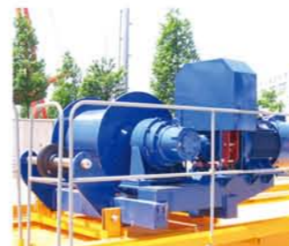
PT7528、PT7023 塔机的三大机构采用全变频控制, 调速性能好, 整机运行平稳、冲击小。
