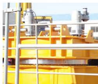
PT7528、PT7023 塔机的三大机构采用全变频控制, 调速性能好, 整机运行平稳、冲击小。
